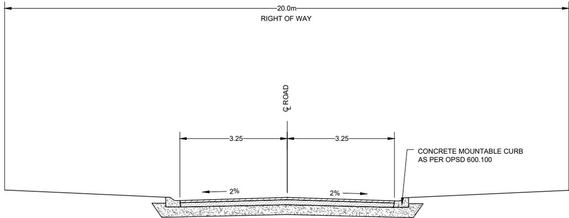
**TYPICAL ROAD CROSS SECTION - 20 m R.O.W.**
