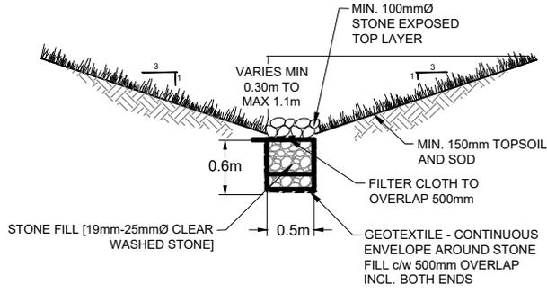
**TYPICAL FLAT BOTTOM INFILTRATION SWALE**
